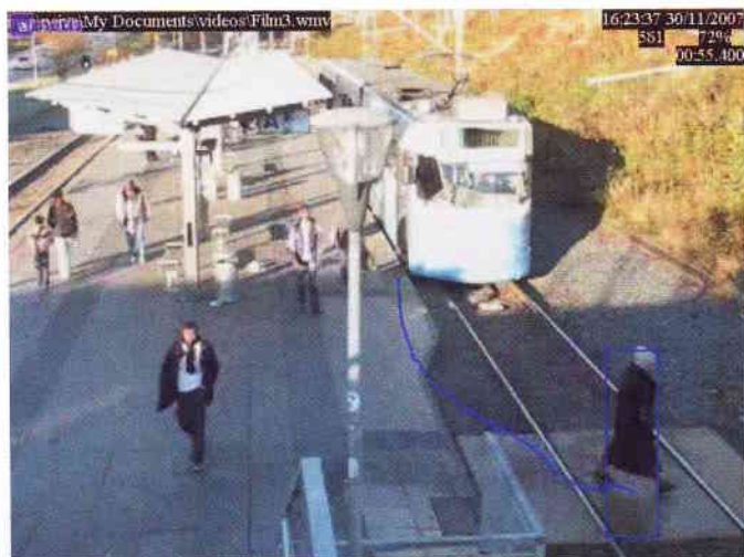
Objekte in einer zu überwachenden Szene werden verfolgt und klassifiziert, rechts die Erkennung von Objekten
